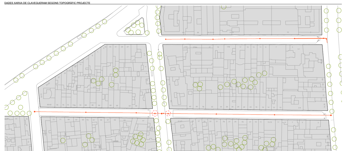
DADES EXISTENTS DE LA XARXA DE CLAVEGUERAM ANTERIORS AL GIS DE AJUNTAMENT DE BADALONA
