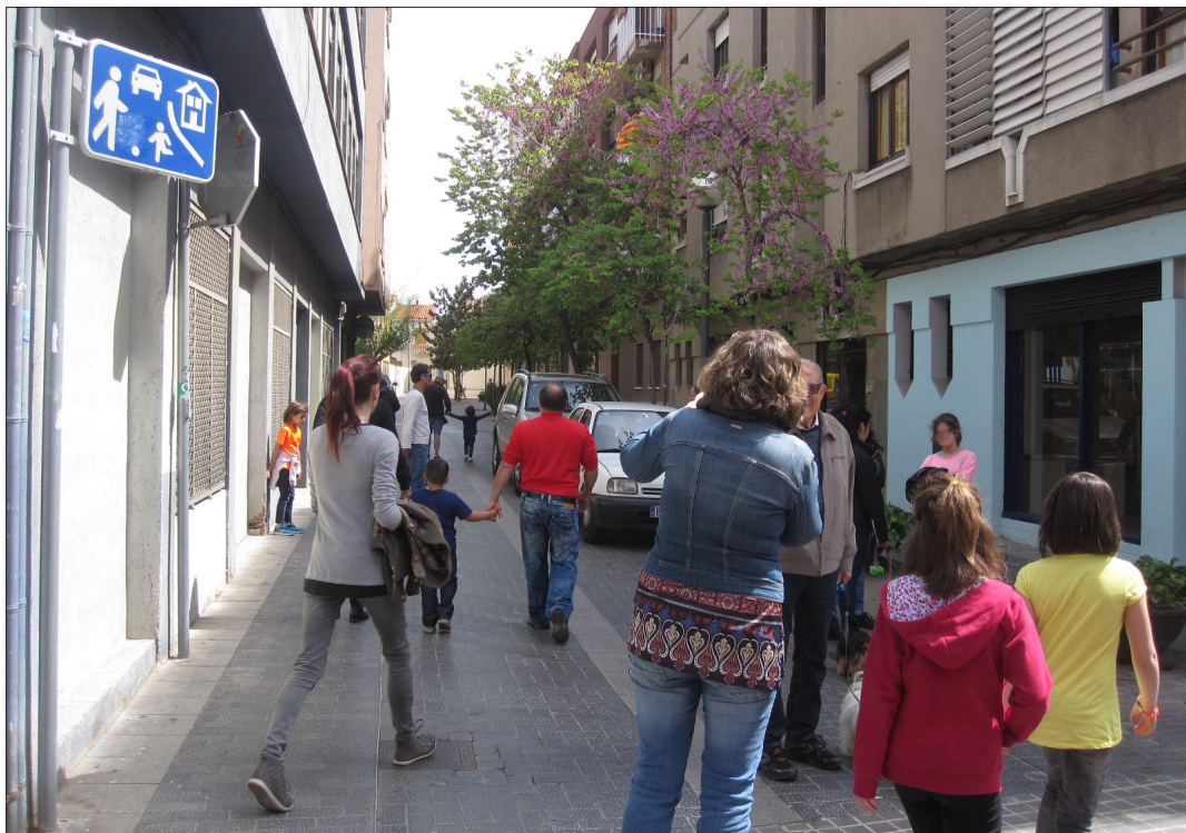
Carrer amb el senyal S-28 i transformat en plataforma única
