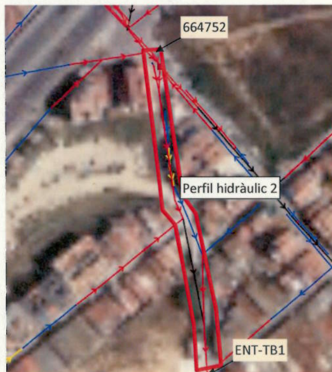
Figura 4. Comportament del col·lector del carrer de la Batllòria per a 10 anys de període de retorn. Color blau: funcionament en làmina lliure, groc: funcionament entre el 75% -99% de la capacitat del col·lector; vermell: col·lector treballant al 100% de capacitat i negre (falta de capacitat hidràulica).
