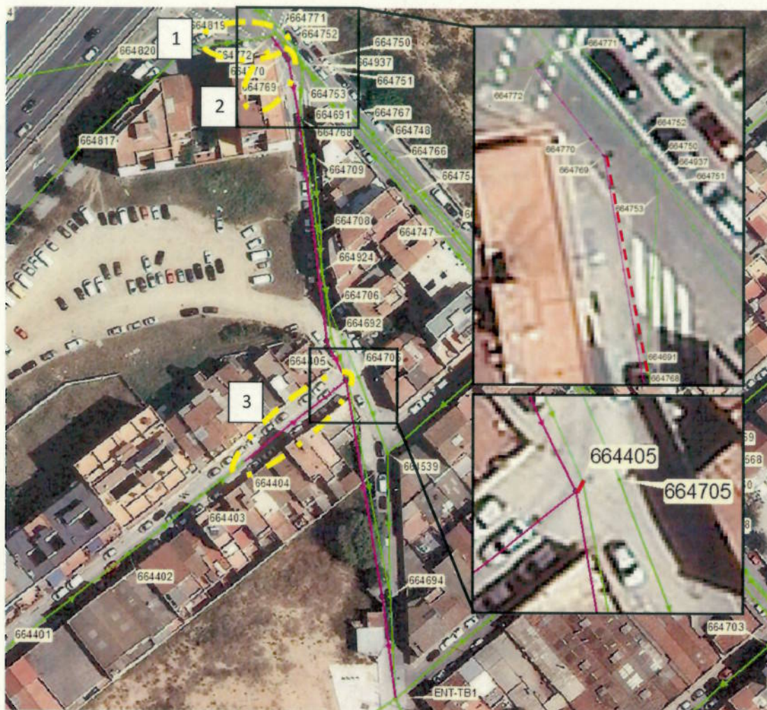
Figura 9. Croquis de la proposta 2. En lila, la proposta del nou col·lector i en vermell les desconexions.
