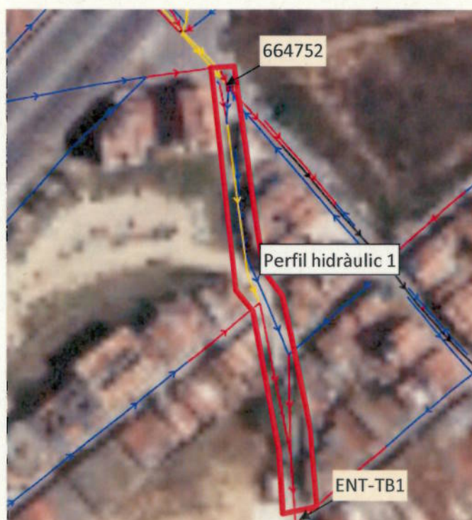
Figura 2. Comportament del col·lector del carrer de la Batllòria per a 2 anys de període de retorn. Color blau: funcionament en làmina lliure, groc: funcionament entre el 75% -99% de la capacitat del col·lector; vermell: col·lector treballant al 100% de capacitat i negre (falta de capacitat hidràulica).
