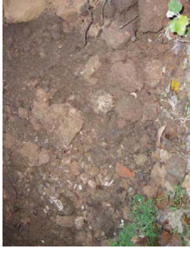
Detall dels materials de reblert extrets durant la cala C-3.
