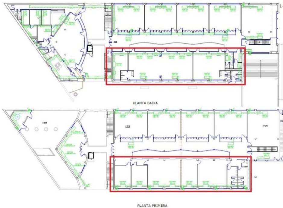
Figura 6. Aules amb mal funcionament de radiadors, planta baixa i primera
