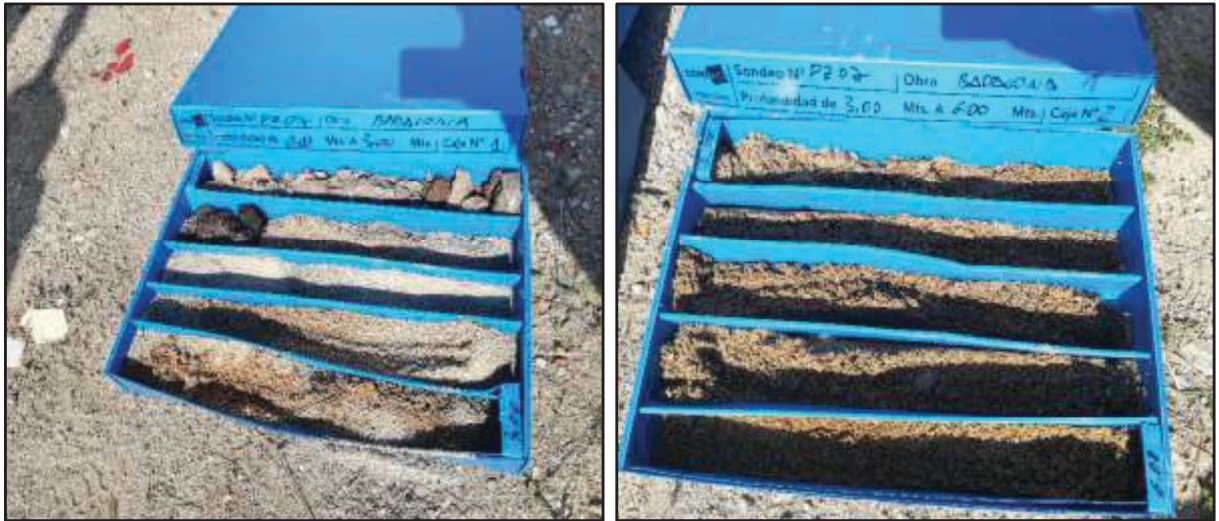
Cajas porta-testigos PZ-07
