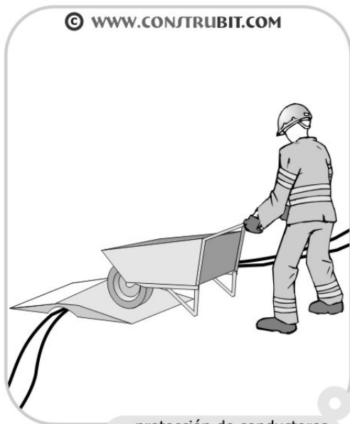
protección de conductores
