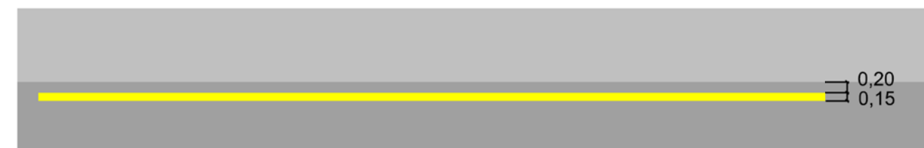
E-12. Línia de prohibició de parada
