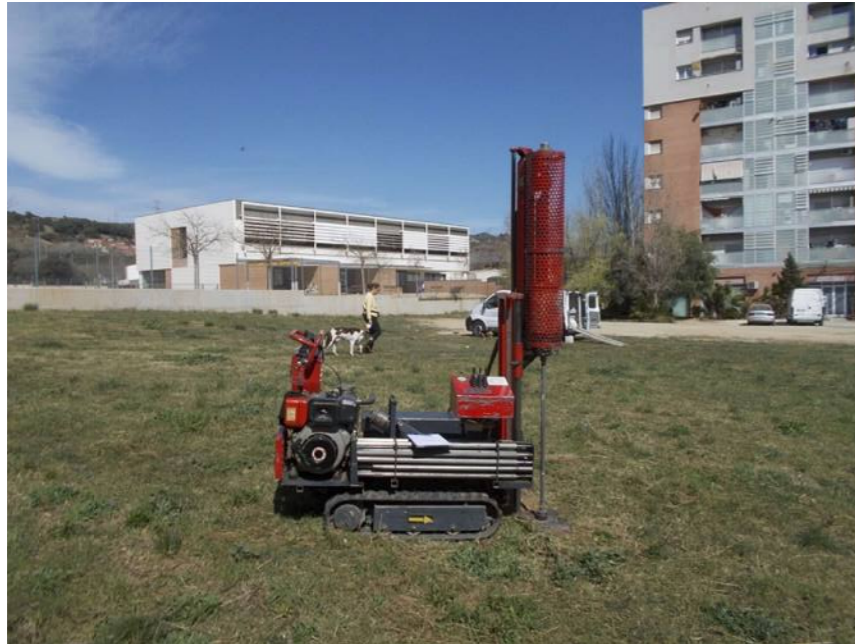
Fotografies 11 i 12. Detall assaigs DPSH.
