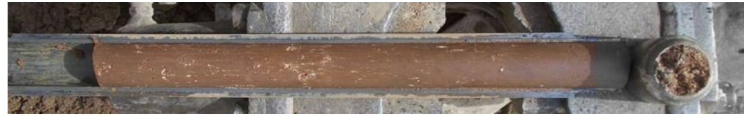
Fotografia 2, 3, 4, 5 i 6. Assaigs SPT's primer sondeig
