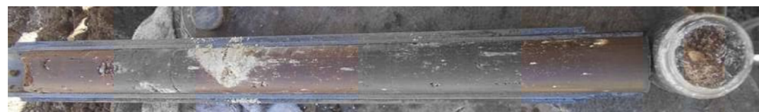
Fotografia 8. Assaigs SPT's segon sondeig
