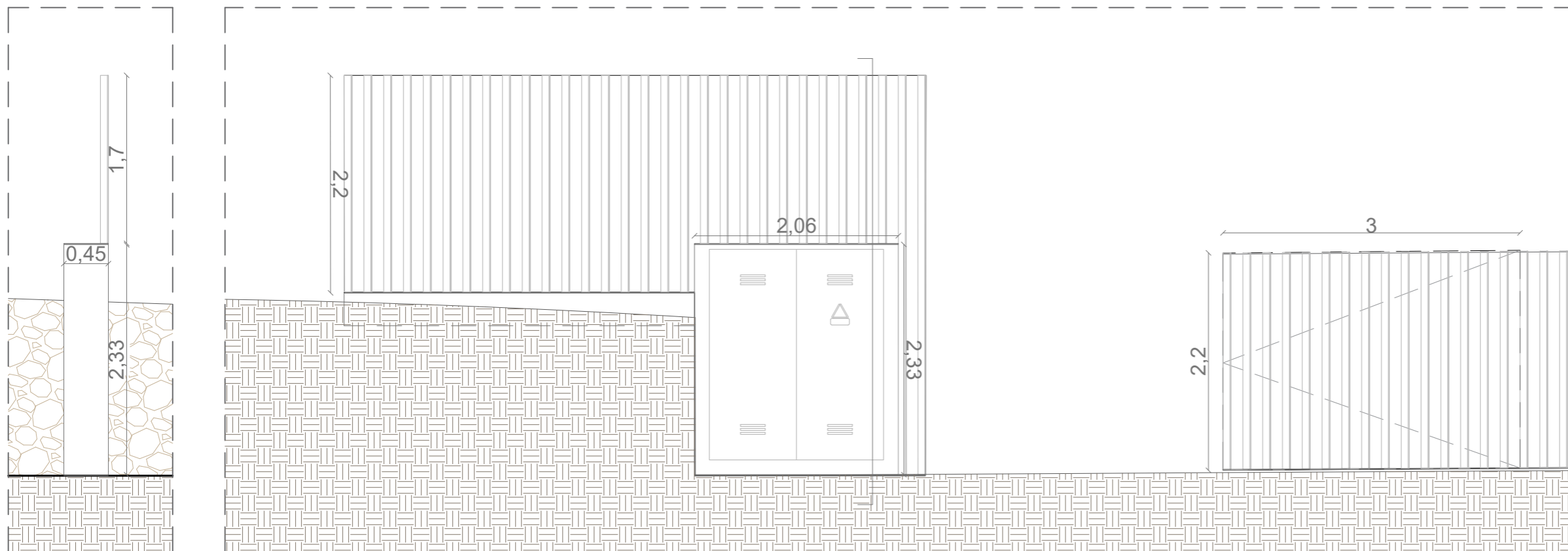
Detall posició quadre elèctric. ESC:1.50
