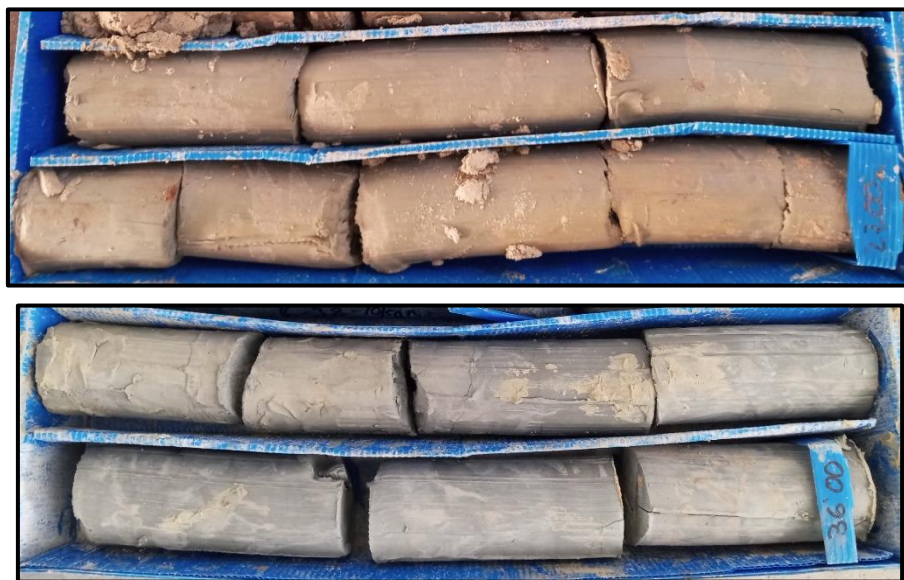
Detall de les argiles de la capa E, de color ocre a sostre, i grises en profunditat. La consistència del substrat competent es trona més alta en profunditat, trobant trams semicimentats amb consistència de roca tova.
