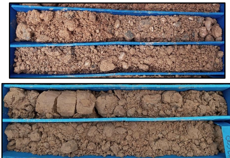
Imatges dels diferents trams sorrencs que conformen la capa D. A dalt, sorres de gra mig a groller, amb graves. A baix, sorres fines i llimoses.
