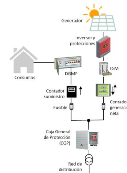
Figura 4. Esquema connexió fotovoltaica
