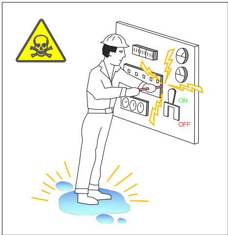
REPARACIÓ D'EQUIPS SOTA TENSIO
