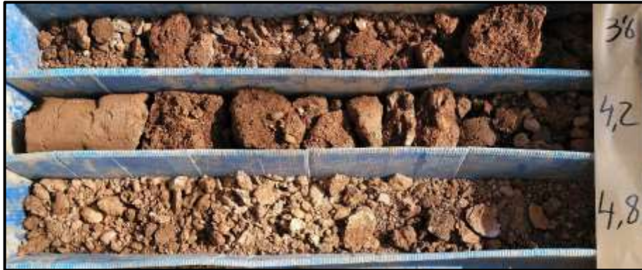
Aspecte general dels materials de rebliment de la capa R que apareixen en el sondeig S-2, i que arriben fins a una profunditat de 5 metres respecte la superfície del terreny.
