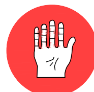
RISC DE CORROSIÓ
