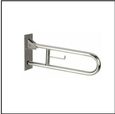
EB10: Barra abatible amb portarotlles Barra abatible ø30-40mm per fixar a paret de gir vertical amb portarotlles. Acabat acer inox satinat. Soportará una força de 1kN. Inclou kit anticonductiu. Model BG0800C de MEDICLINICS o equivalent. Unitats: 2
