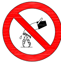
PROHIBIT APAGAR AMB AIGUA
